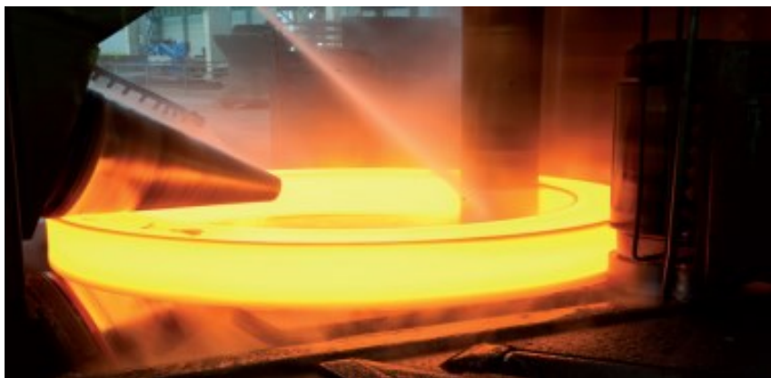
Processo di laminazione a caldo di un anello di grosse dimensioni
